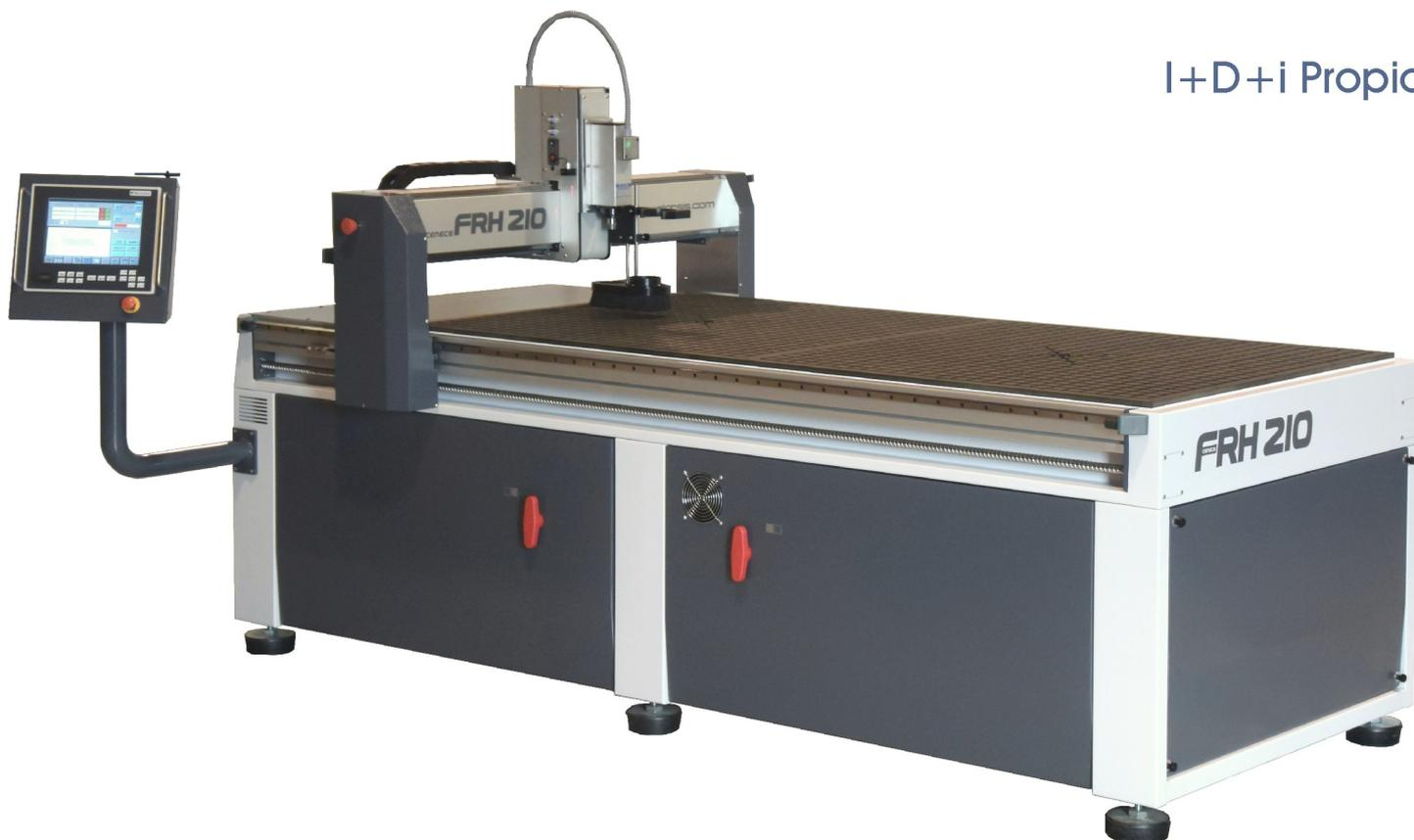
Modelo de producción para mecanizados donde se requieran prestaciones tanto de potencia como de precisión. Muy robusta y con bajo mantenimiento, características de toda la serie FRH. Con transmisión por husillos a bolas en todos los ejes con nuestro exclusivo sistema de tuerca rotativa y cambiador automático de herramientas en opción. Área útil de trabajo de 200x100cm y altura de 120mm.
